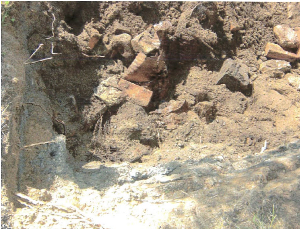
Figur 2-13 Foto från provgropsgrävning 2005 där fyllnadsmassor ses och som tydligt avviker från naturliga jordarter. Fotot från IBA 2005
