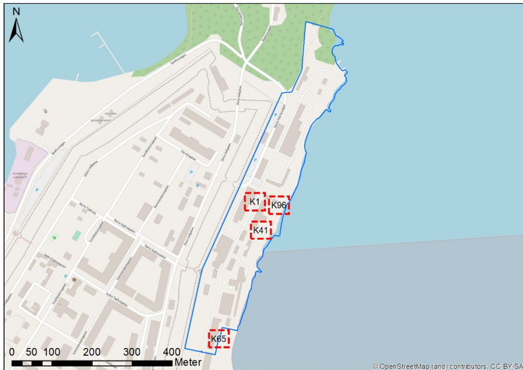
Figur 1-1 Avgränsning av undersökningsområde för nya provtagningspunkter vid undersökning 2021. Grundvattenprovtagning genomförs över hela fastigheten (blå linje) medan de fyra rödmarkerade områdena omfattade utökad undersökning. Övriga delar av kartan utgörs av fastigheten Vanäs 1:9. Den del av Vanäs 1:9 som inkluderades i undersökningen syns nederst i bild inom en av de fyra rödmarkerade områdena. Bakgrundskarta: OpenStreetMaps och bidragsgivare.
