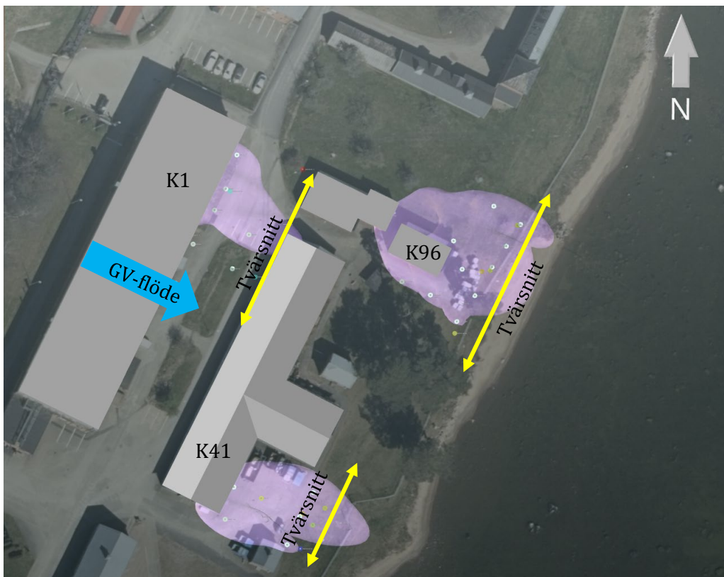
Figur 4-5 De tre tvärsnitten som används för att beräkna föroreningstransport inom den norra delen av området.
